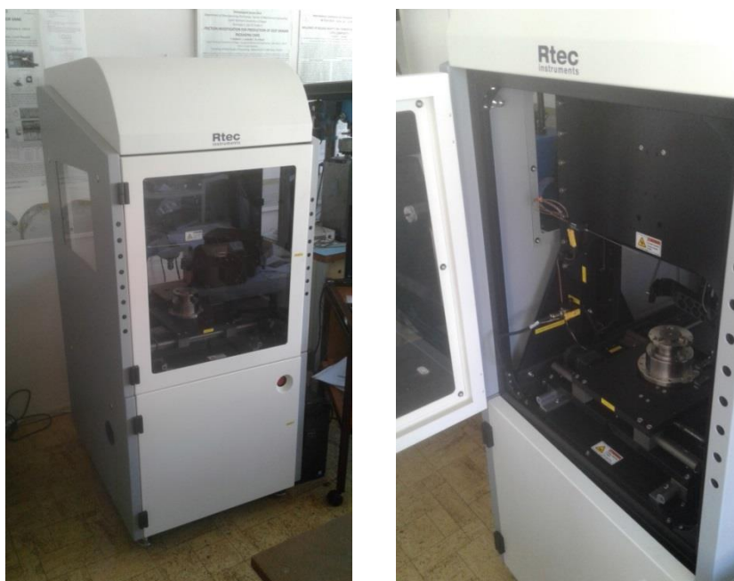
Obr. 18: Zařízení MFT-5000 Multi functional Tribometer
