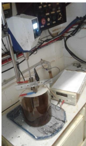
Obr. 5: Experimentální elektrolyzér s hřídelovým míchadlem
