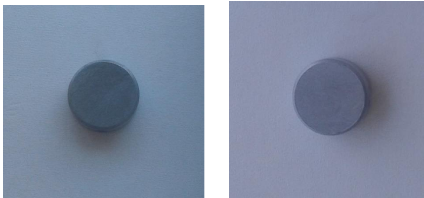
Obr. 10: Vzorky pro tribometr TOP 3: Vlevo povlak ZnNi, vpravo kompozitní povlak ZnNi
