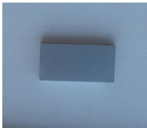
Obr. 19: Vzorek pro lineární pohyb tribometru [interní materiály ústavu, foto autora]
