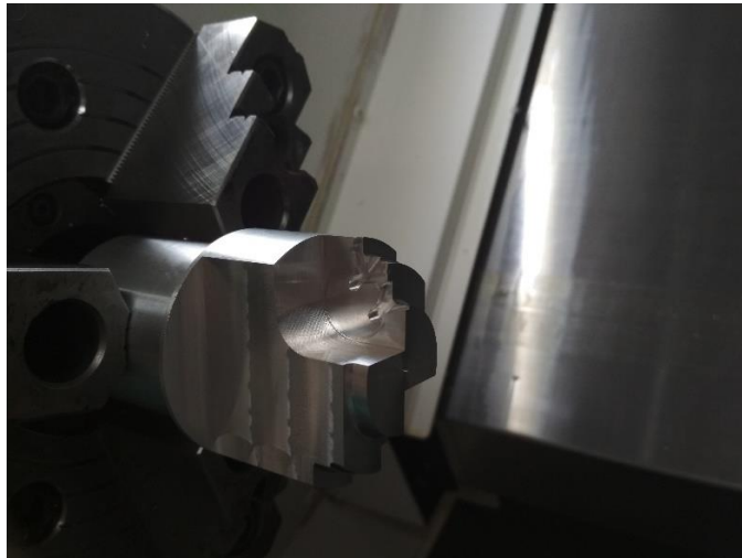
Obrázek č.40 Frézování kapes pro VBD
