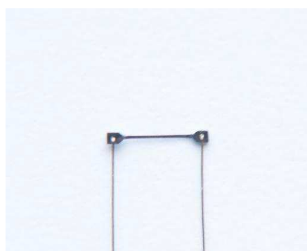
Obr. 9: Tenzometr bez podložky [11]
