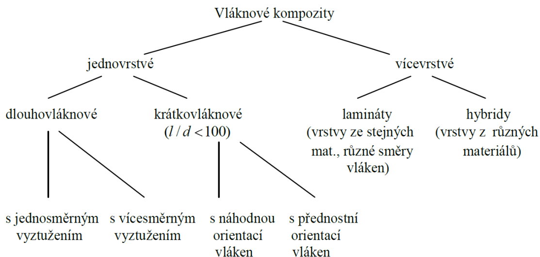
Obr. 8 Klasifikace vláknových kompozitů z geometrického hlediska [3]
