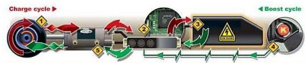
Obr. 11 – Funkce KERS systému [4]
