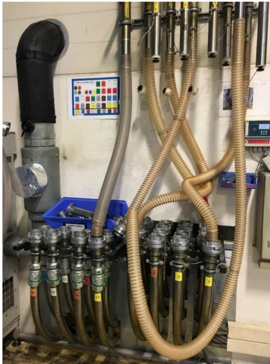
Obrázek 11 Zařízení pro nasátí a doprava granulátu pomocí trubic [13]
