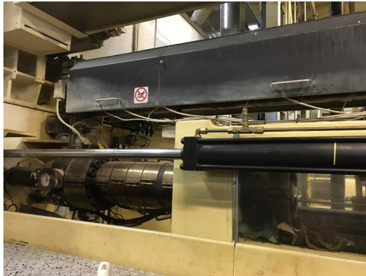
Obrázek 15 Ohříváč směsi v horní části fotografie, pod ním šnek, vpravo dole píst [13]
