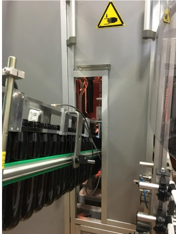
Obrázek 19 Preformy zajiždějící do pece [13]
