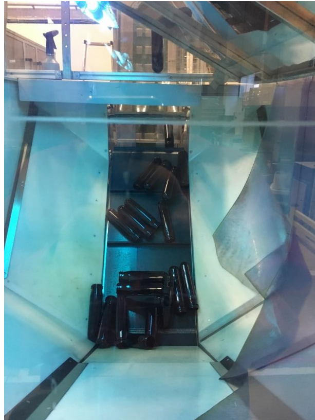
Obrázek 18 Ošetření preforem UV zářením [13]
