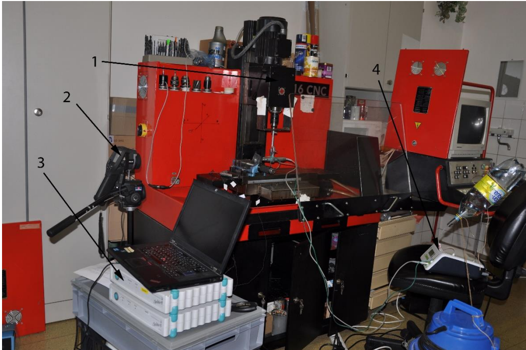
Obrázek 15 Instalace experimentu: 1 - CNC frézka; 2 - Termokamera; 3 - Tenzometrická ústředna SPIDER 8; 4 - Stomatologická jednotka
