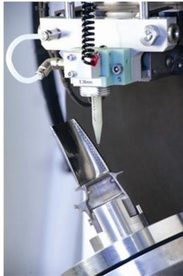
Obr. 17 EDM vrtání turbínové lopatky [38]
