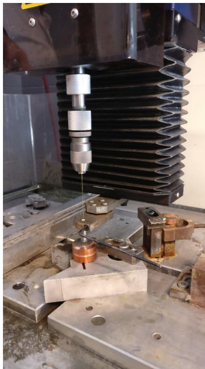
Obr. 16 Vrtání měděné trysky mosaznou elektrodou 0,2 mm, PENTA EDM
