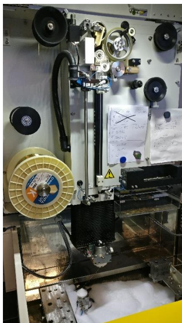
Obr. 20 Pohled na odvíjecí mechanismus a vodící hlavy, Penta EDM Říčany
