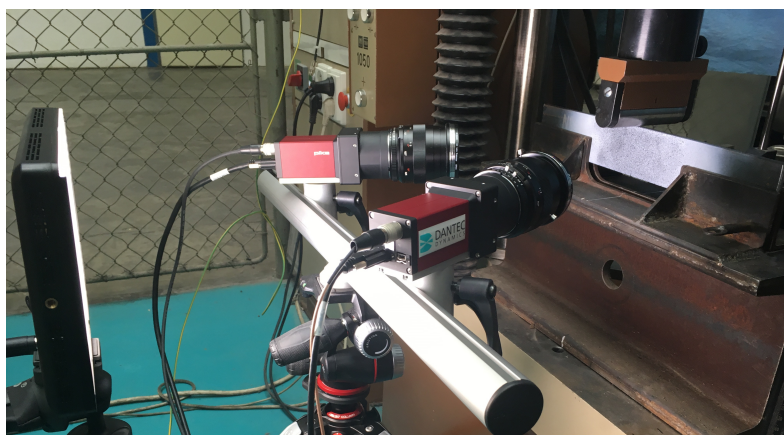
Obrázek 3.9: Uspořádání měření při 3D korelaci obrazu
