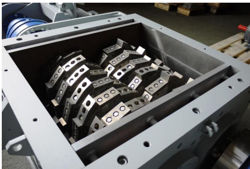
Obr. 11. Drtič na osobní pneumatiky SCE 700/950 30 kW od firmy Terier [29]
