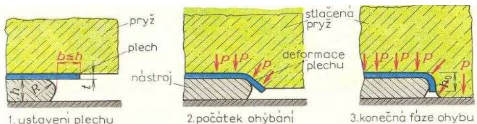
Obr. 13 – Schéma ohýbání metodou Guerin [11]
