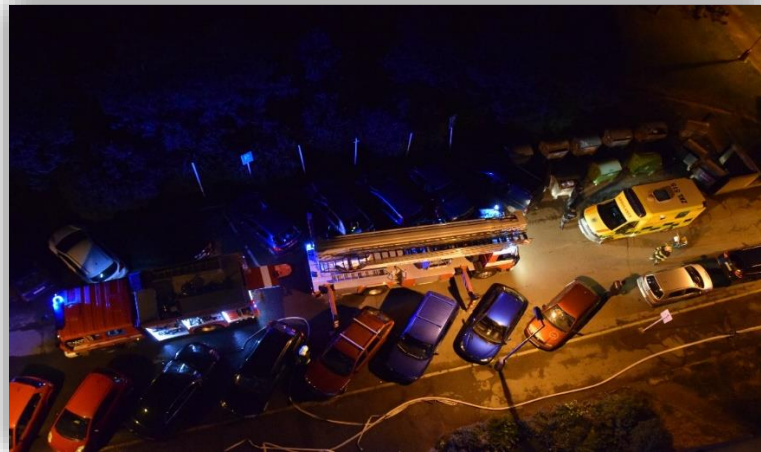
Obr. 8 - Problematické ustavení výškové techniky při požáru v Příbrami [20]
