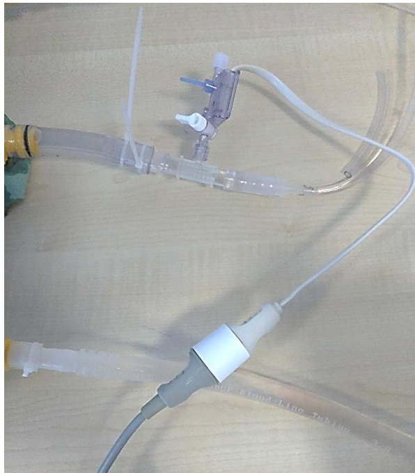
Obr. 4.2: Připojení sondy normálně používanou pro měření IBP na měřicí soustavu (na foto je jen z jedné strany)
