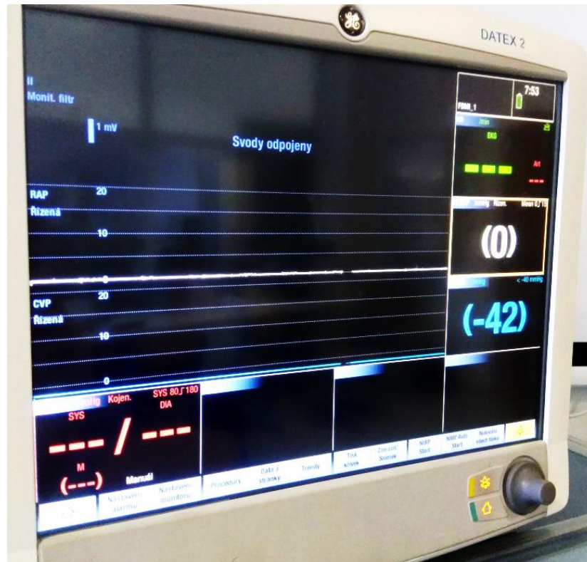
Obr. 4.3: Připojený monitor životních funkcí pro měření tlaku v hadici ( \varnothing 4, Q = 6 L/min)
