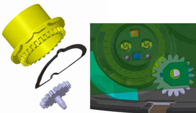
Obrázek 6: Příklad konstrukce při použití potenciometru
