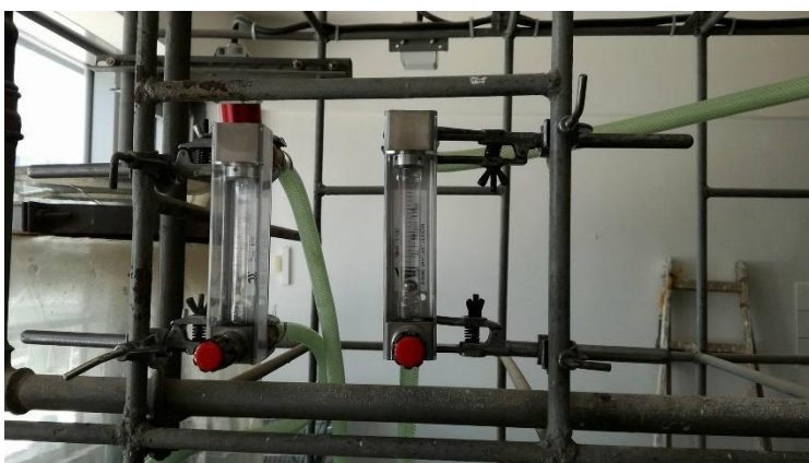
Obr. 16 Měření průtoku vody
