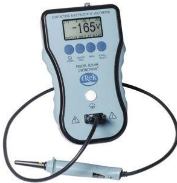
Obr. 10.3 Kontaktní elektrostatický voltmetr ESVM 821HH (převzato z [25])
