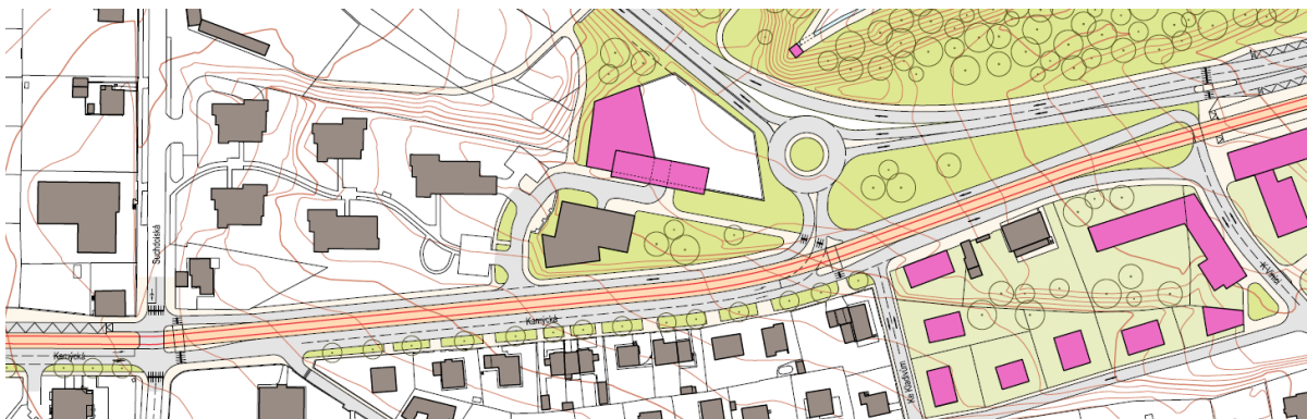
Obrázek 22 - Osové vedení trati od křižovatky Rybářka (D3A, 2017) – toto řešení přináší jen zde dva zbytečné kolizní body při křížení ulice a trati
