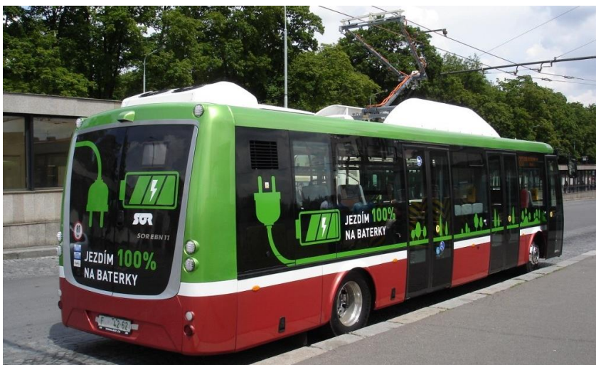
Obrázek 33 - testovaný elektrobuses SOR EBN11 s pomalým dobíjením pro dlouhý dojezd v obratišti Želivského vykonávající odstav a dobíjení akumulátorů (foto: idnes.cz)
