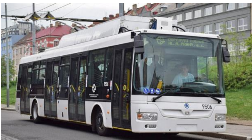
Obrázek 34 - testovaný parciální trolejbus Škoda 30Tr v obratišti Palmovka vykonávající odstav a dobíjení akumulátorů (foto: auto.cz)
