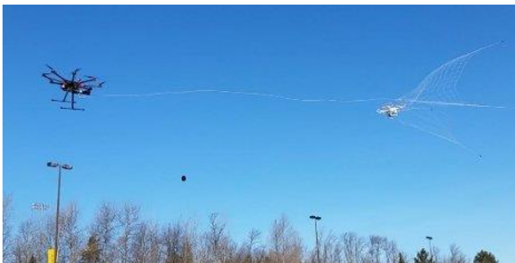
Obr. 14 Dron s vystřelovací sítí vyvinutý na Michigan Technological University [43]
