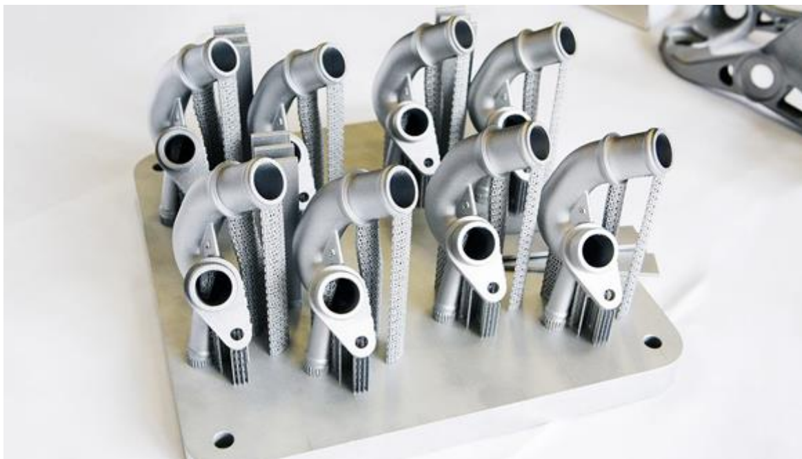
2. 10 Část pro Audi W12 vytvořená metodou práškového lože [8]
