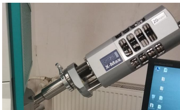
5. 17 EDS analyzátor OXFORD Instruments INCA 350
