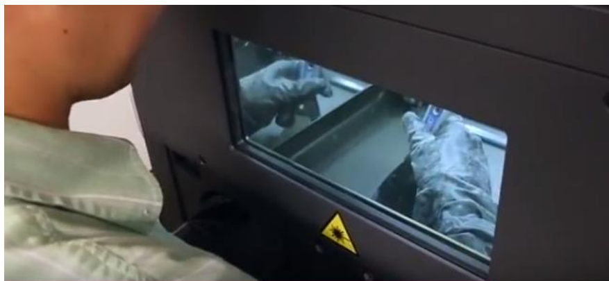
5. 9 Integrované rukavice pro práci v ochranné atmosféře [35]
