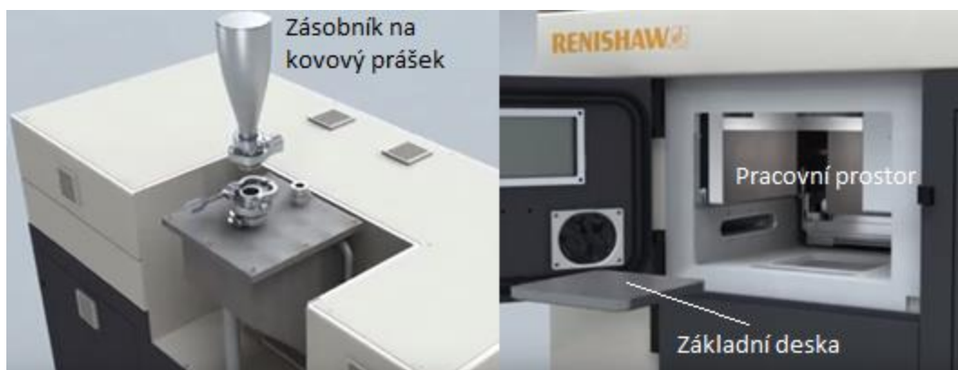
5. 3 Vlevo: Připevnění zásobníku, Vpravo: Vložení základní desky do pracovního prostoru [34]
