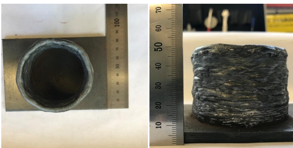
Obr.26 Navařování zkratem 40 vrstev
