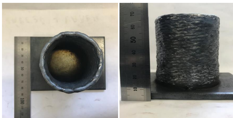
Obr.35 Navařování metodou CMT 50 vrstev
