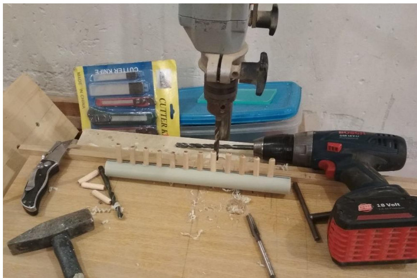
Obrázek 31 – Výroba kouřového hřebene
