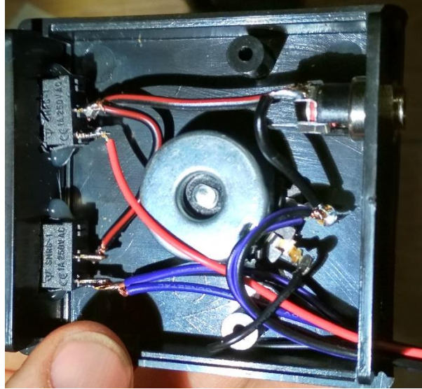
Obrázek 33 – Detail zapojení ovládacího panelu
