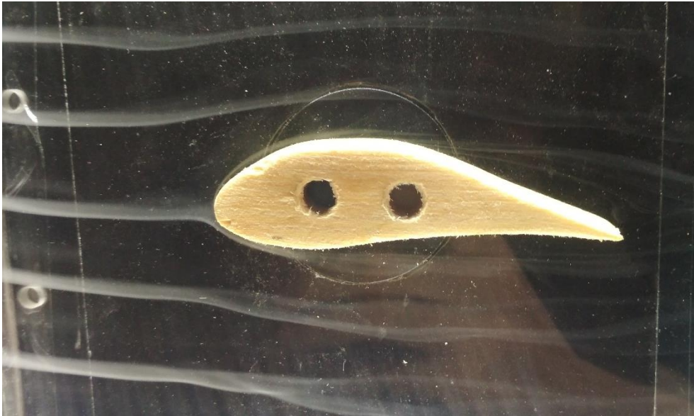
Obrázek 41 - Vizualizace obtékání leteckého profilu
