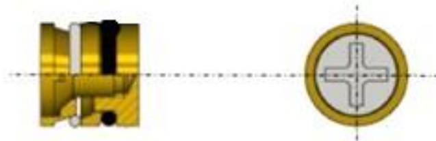
Obr. 12.: Ucpávka s pryžovým „O“ kroužkem, výrobce MEUSBURGER. [10]
