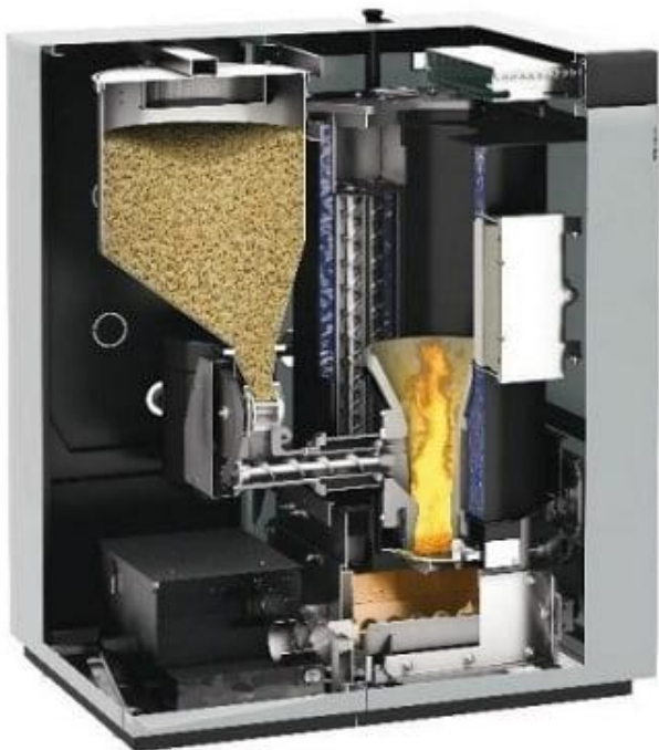
Obrázek 5: Zásobník s palivem přímo v prostoru kotle [15]
