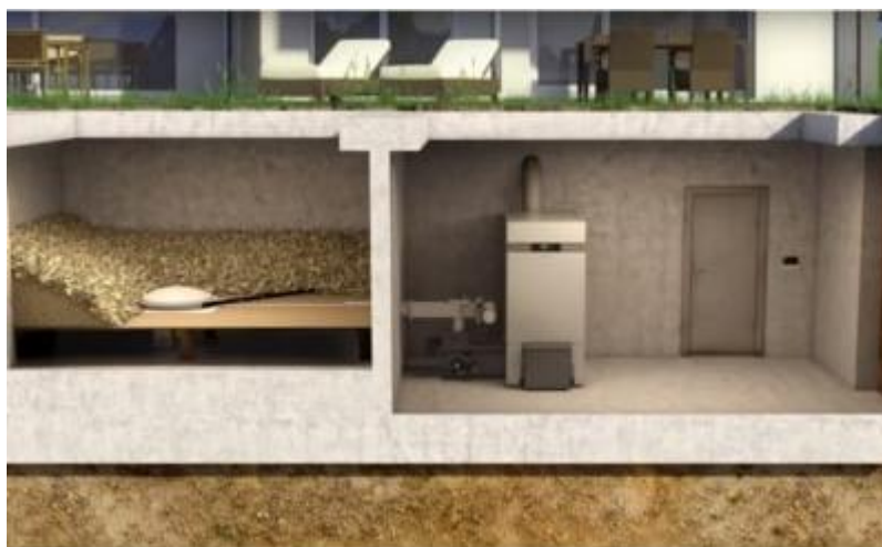
Obrázek 6: Skladování pelet v samostatné místnosti [15]
