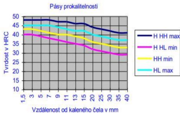
Obr. 16.: Pásy prokalitelnosti materiálu 18CrNiMo7-6 [4]
