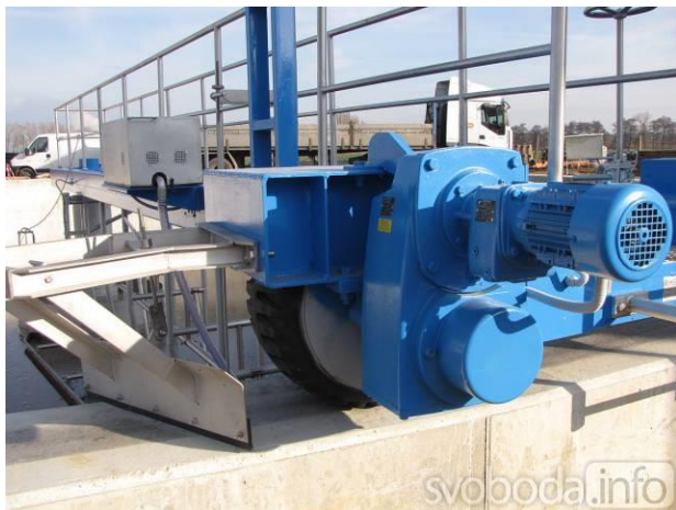
Obrázek 2 Pohon otáčivé lávky pomocí vícestupňové převodovky s čelním ozubením [14]
