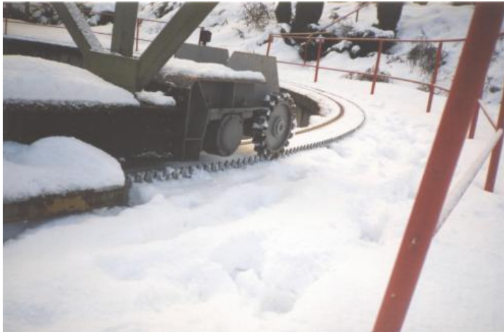
Obrázek 5 Realizace pohonu pomocí zubačky a kolejnice [18]
