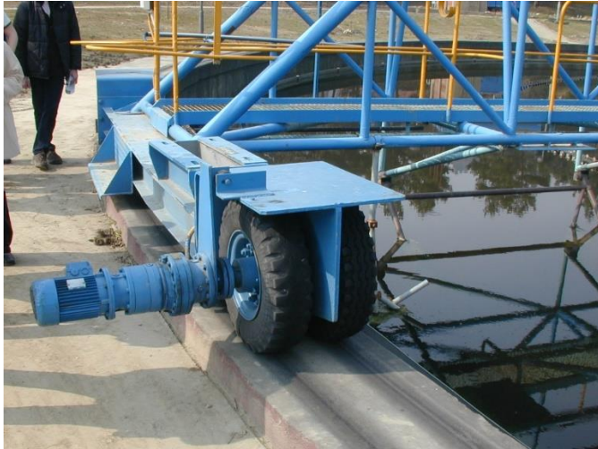
Obrázek 4 Pohon otáčivé lávky pomocí planetové převodovky [16]
