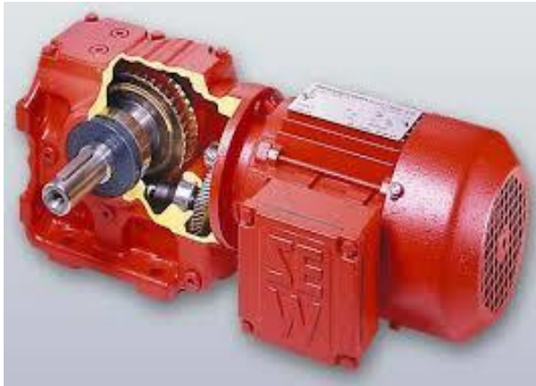
Obrázek 13 Šneková převodovka s čelním předstupněm [8]
