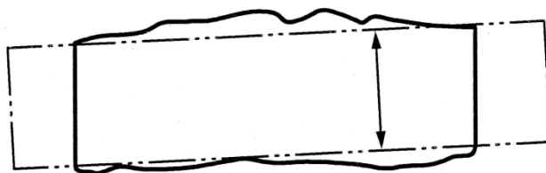
Obrázek 7 Příklad maximálního vepsaného rozměru [1]
