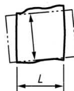
Obrázek 5 Rozměr části získaný kritériem maximálního vepsaného rozměru [1]
