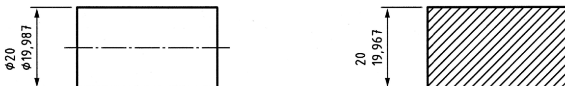
Obrázek 18 Příklad tolerování minimálního a maximálního rozměru - typ rozměru válec a dvě rovnoběžné protilehlé roviny [1]
