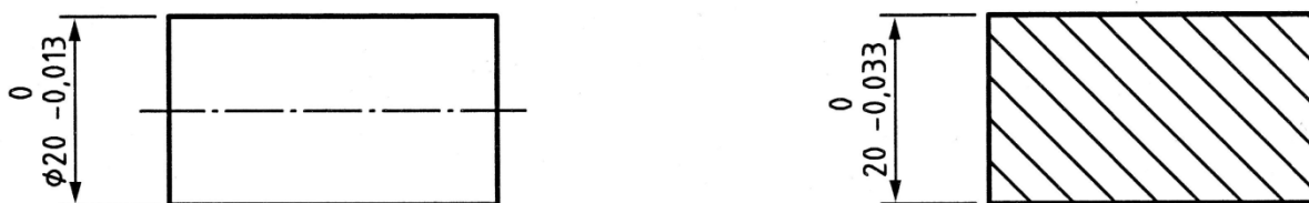
Obrázek 17 Příklad tolerování minimální a maximální odchylky - typ rozměru válec a dvě rovnoběžné protilehlé roviny [1]
