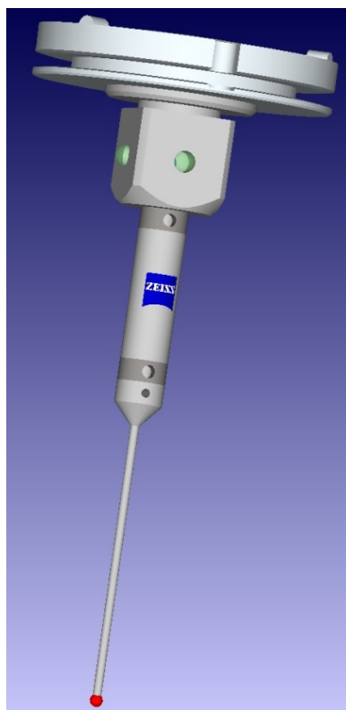
Obrázek 62 Snímací systém vytvořený v programu Calypso 2017
