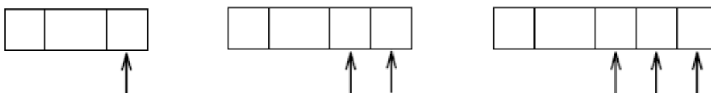
Obrázek 14: Umístění písemné značky (značek) základny v orámované toleranci
