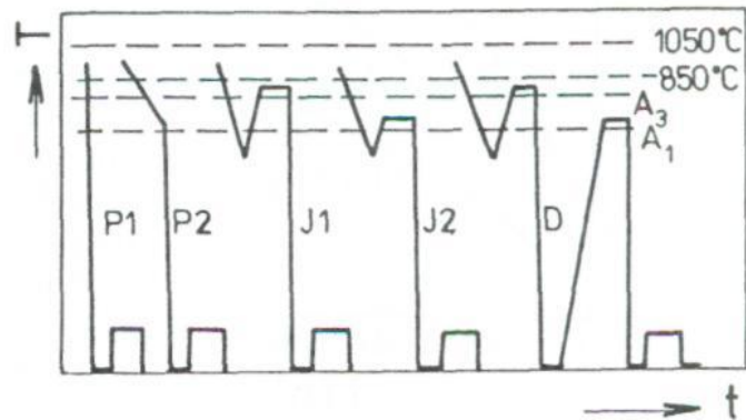
Obr. 4-45 Schéma průběhu tepelného zpracování po nauhličení při cementování: P - přímé kalení, J - jednoduché kalení po ohřevu, D - dvojité kalení
