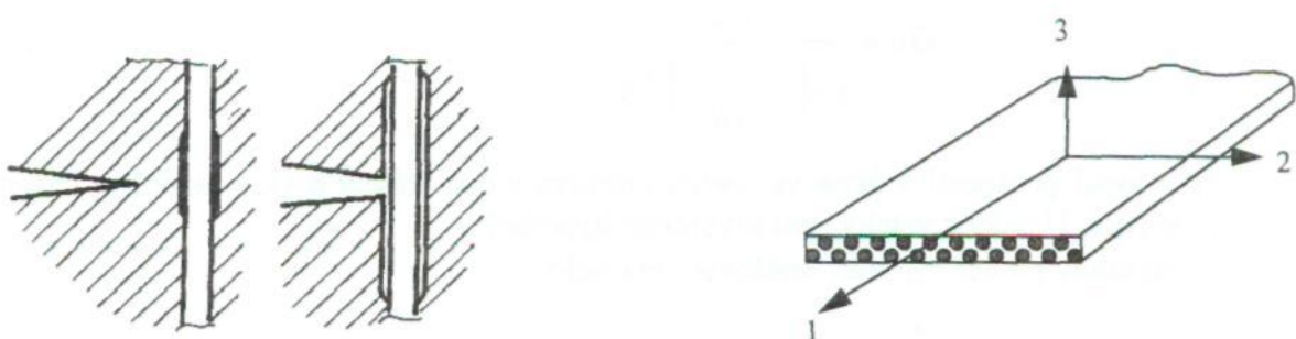
Obr.6-5 (vlevo) Mechanismus interakce trhliny matrice s vláknem.
