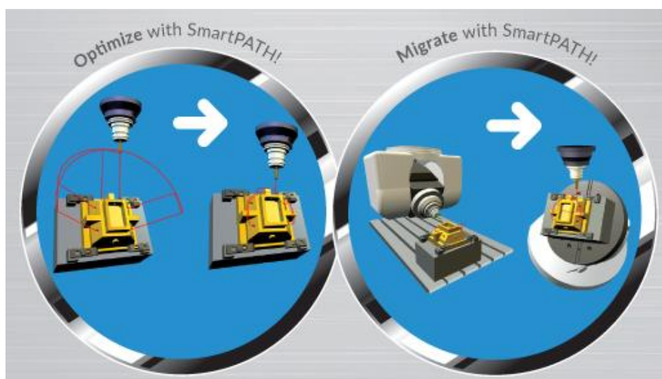
Obr. 3-4 - ICAM grafické znázornění rozdílů dráhy nástroje před (nejvíce vlevo) a po (druhé zleva) po použití SmartPATH, převzato z lit. [7]
