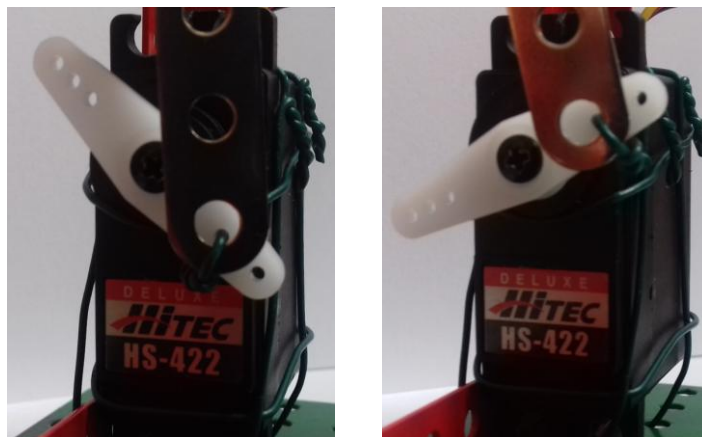
Obrázek 19: Otočení táhla servomotoru do krajních pozic používaných při simulacích
