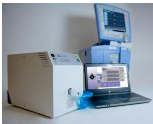
Obrázek 13: simulátor plic ASL 5000 od firmy IngMar – převzato z [22]
