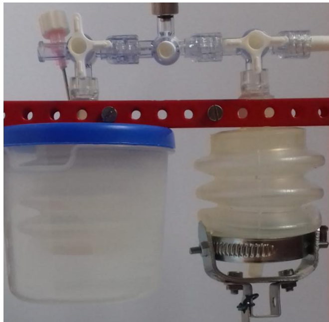
Obrázek 17: Detail navrženého simulátoru - uchycení dvoukompartmentového modelu plic
