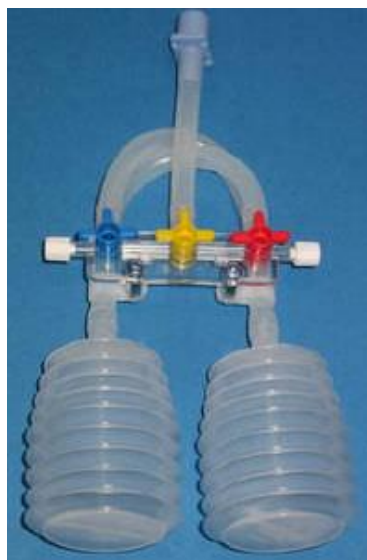
Obrázek 10: Novorozenecká testovací plíce od firmy Imtmedical – převzato z [24]
