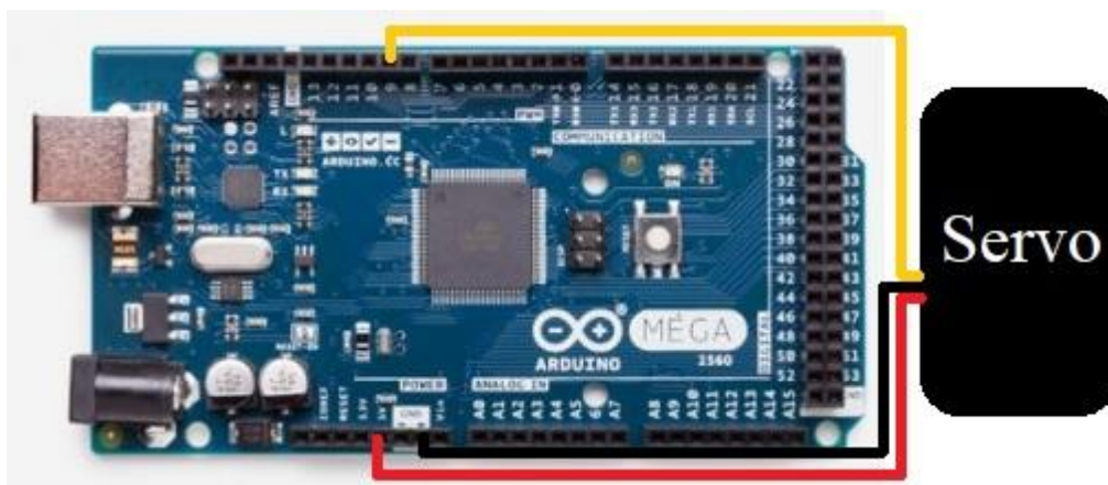
Obrázek 21: Propojení serva s Arduinem. – upraveno [29] Signál – pin 9, napájení – pin 5V, zemnění – pin GND
