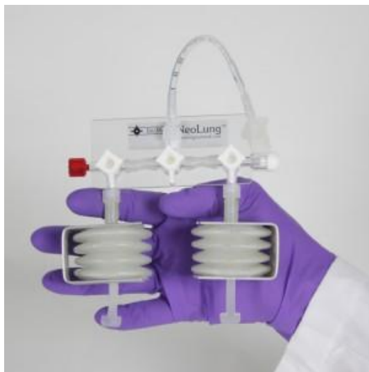
Obrázek 11: Novorozenecká plíce Neolung od firmy IngMar Medical – převzato z [19]
