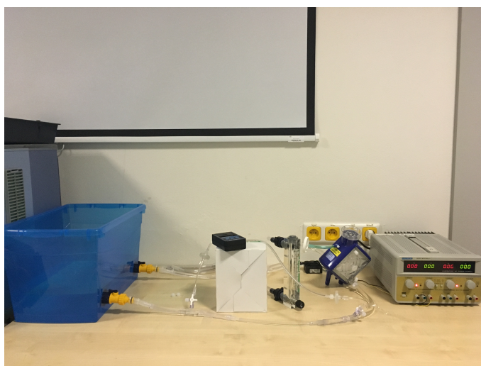
Obr. 2.2: ECMO okruh sestavený v laboratorním prostředí.
