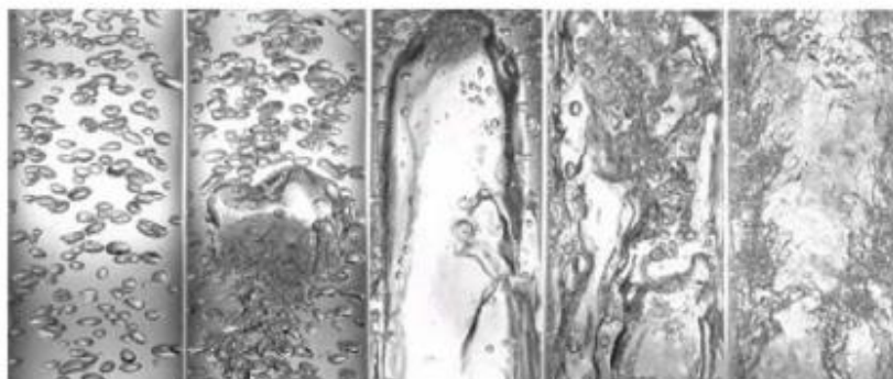
Obrázek č. 2: Typické vzory proudění dvoufázové kapaliny vzduch-voda ve svislé trubce o průměru 50,8 mm
