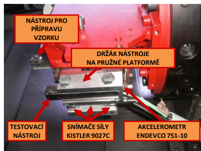
Obr. 7 Držák nástroje se senzorikou
