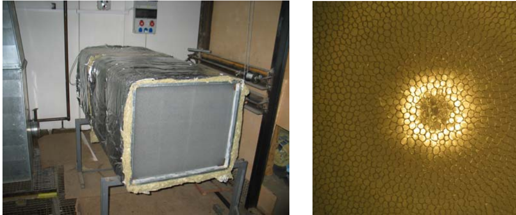
Obr. 4.3.2b – Ukliďňovací komora a detailní pohled na strukturu usměrňovače
