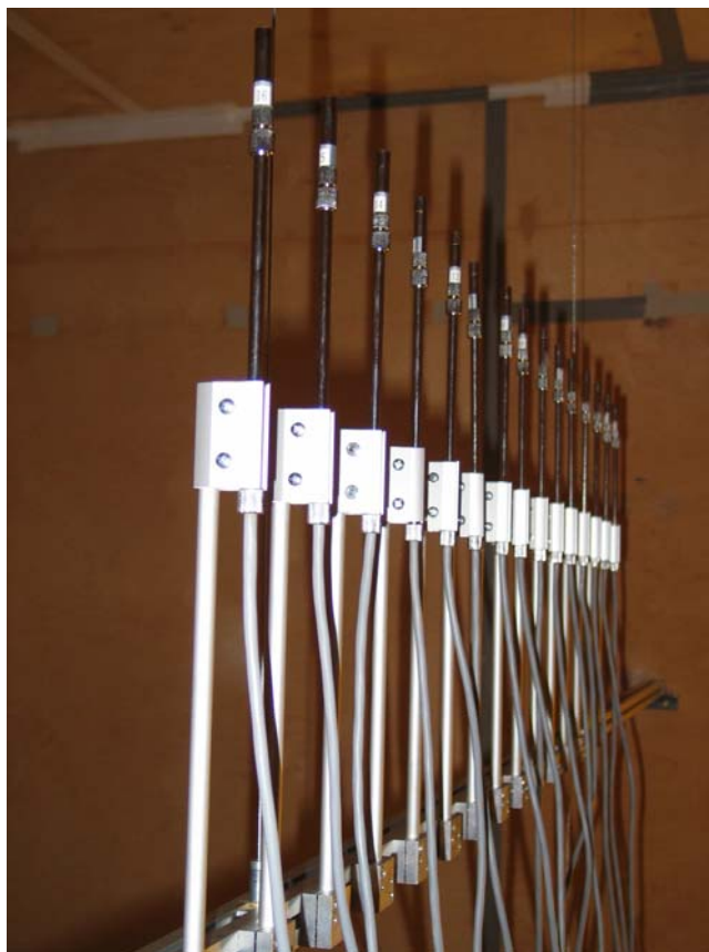
Obr. 3.3.1c – Hřebenová sonda sestavená z anemometrů HT-412 (čidla jsou ukryta v ochranných trubičkách)
