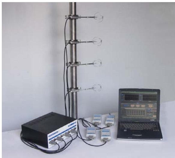
Obr. 3.3.1a – Příklad sestavy termoanemometrů HT-400 (převzato z technické dokumentace výrobce)
