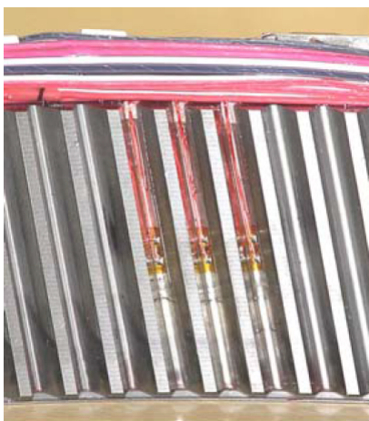
Obr. 2.29: Tenzometrické měření zubu [13]
