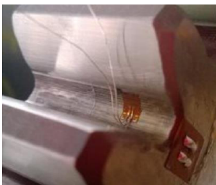
Obr. 2.28: Tenzometrické měření zubu [21]
