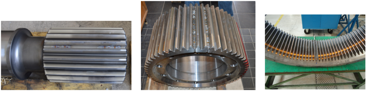
Obr. 5.2: Pastorek, satelit a korunové kolo s instalovanými tenzometry
