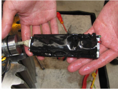
Obr. 5.4: Datalogger a systém měřicího zařízení pro ústředny National Instruments
