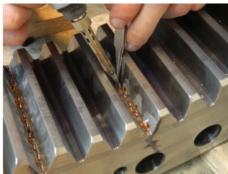
Obr. 4.15: Připojení tenzometrů na pájecí pole
