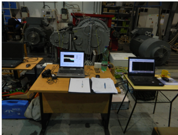
Obr. 5.8: Systém měřícího zařízení pro ústředny National Instruments
