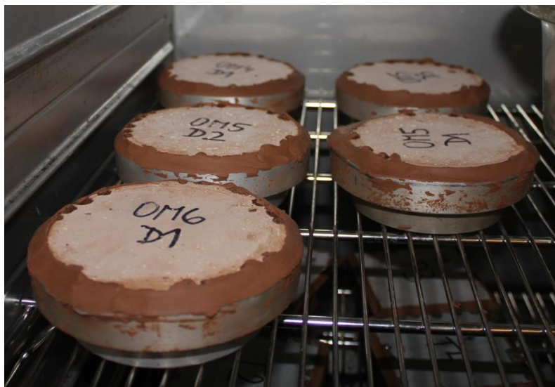
Obrázek 11. Ukázka měření transportu vodní páry pomocí cup metody v klimatické komoře
