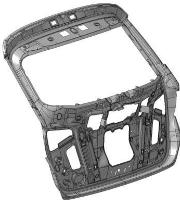
Obrázek 9.20 – Geometrie TM dílu vnitřních pátých dveří vozu SEAT Ateca.
