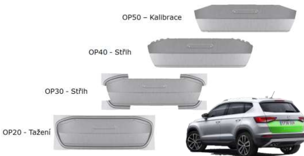
Obrázek 5.1 – Sled lisovacích operací dílu vnějších pátých dveří vozu SEAT Ateca. [P11]
