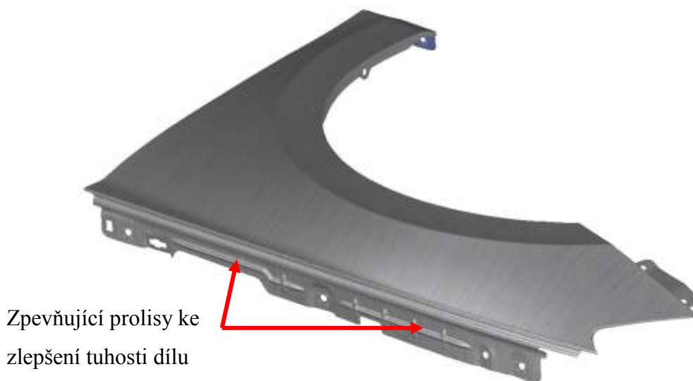
Obrázek 2.19 – Ukázka zpevňujících prolisů ke zlepšení tuhosti dílu na blatníku vozu ŠKODA Superb.
