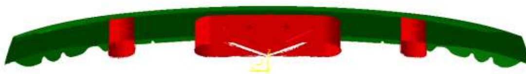
Obrázek 7.8 – Sken výlisku spodních pátých dveří vozu SEAT Ateca (označený zelenou barvou) na zvedačích po tažné operaci (zobrazený v izometrickém pohledu a ve směru osy y). [P7]
