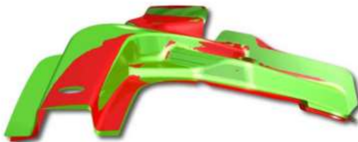
Obrázek 2.3 – Odpružení dílu A sloupku Daimler v porovnání s referenční geometrií. [8]
