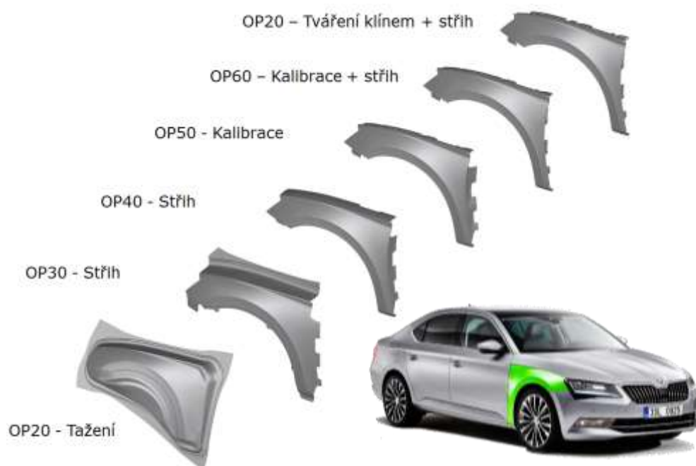
Obrázek 5.3 – Sled lisovacích operací dílu vnějšího blatníku vozu ŠKODA Superb. [P11]
