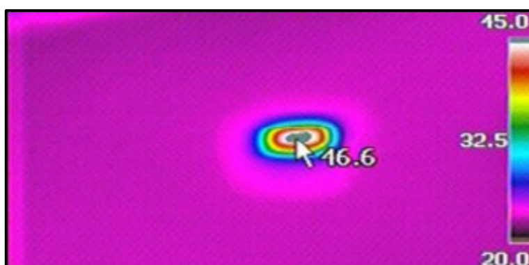
Obr. 7.14b: Snímek z termokamery, lidský nehet podložený vepřovou svalovinou ( 111 \text{ mJ}\cdot\text{cm}^{-2} , 10 Hz, 6 s) [105]
