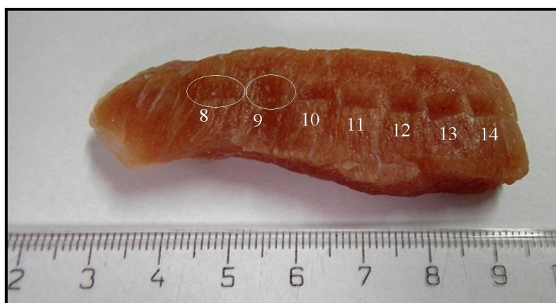
Obr. 7.5: Ablací krátery ve vepřové svalovině ( 770 \text{ mJ} \cdot \text{cm}^{-2} ), vzorek připravený pro CT snímkování [98]
