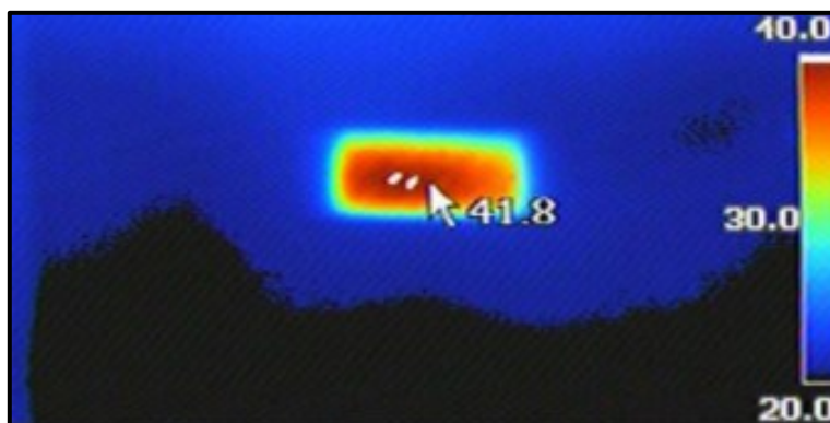
Obr. 7.14a: Snímek z termokamery, vepřová kůže ( 111 \text{ mJ}\cdot\text{cm}^{-2} , 10 Hz, 6 s) [105]
