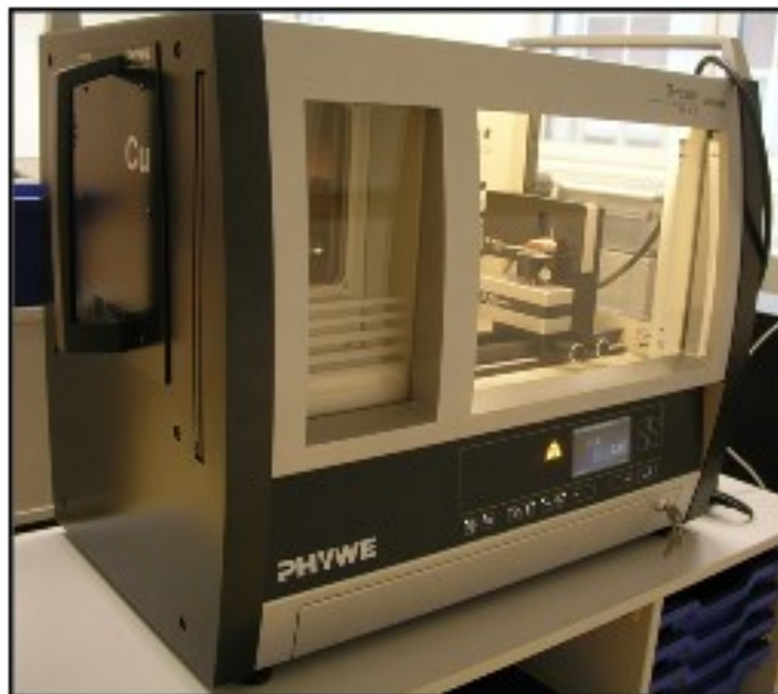
Obr. 5.5: RTG jednotka, PHYWE XR 4.0 s vloženým vzorkem [98]
