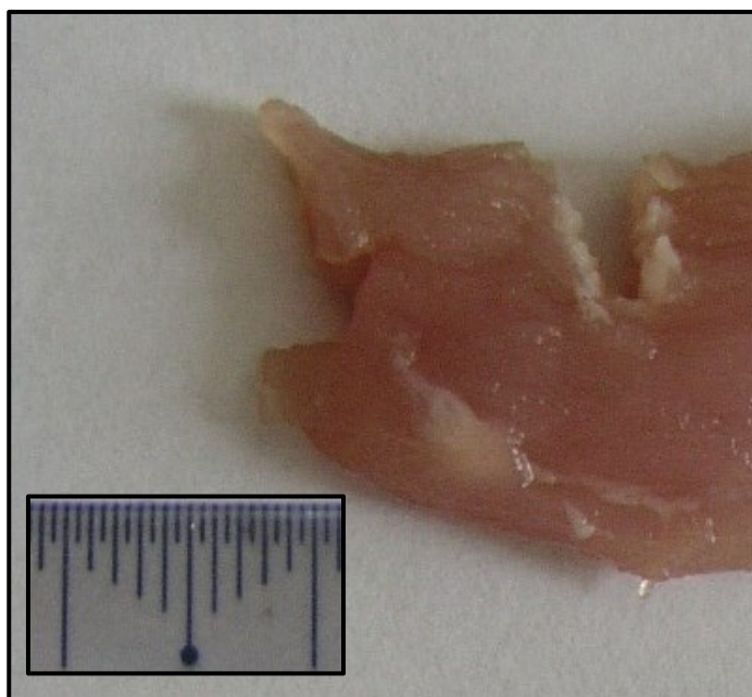
Obr. 8.6: Řez ablačním kráterem s viditelným termálním poškozením okraje, vepřová kosterní svalovina (1270 mJ·cm -2 , 40 Hz)
