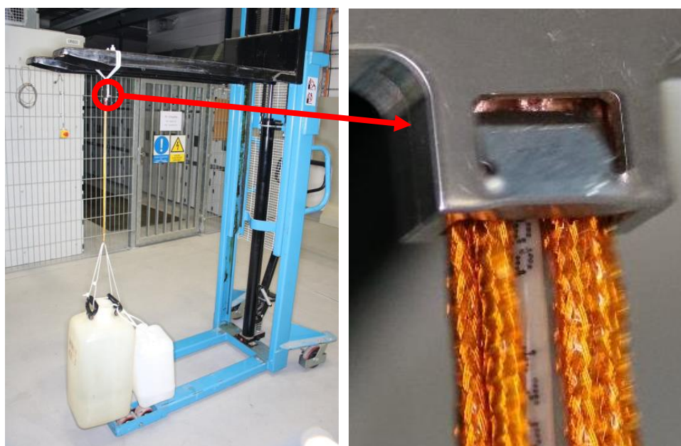
Obr. 5.37 Test kabelové svorky zatížením do 350 N.
