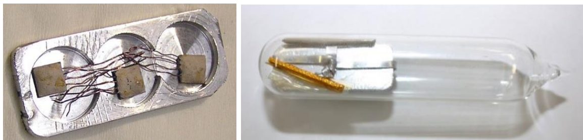
Obr. 5.30 Ozařovací ampule s Hallovými senzory v hliníkovém pouzdru.
