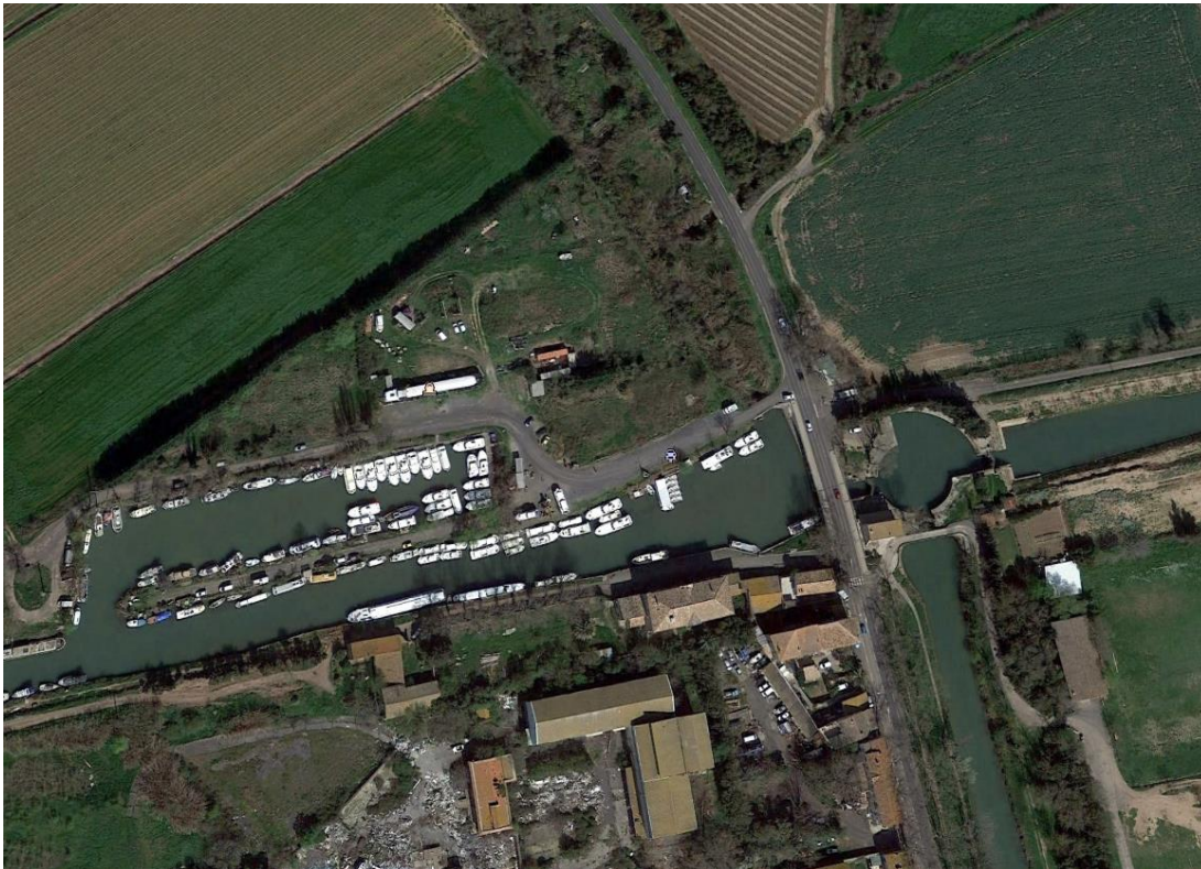
Přístaviště bazénového typu mimo plavební cestu s jedním vjezdem a výjezdem.
