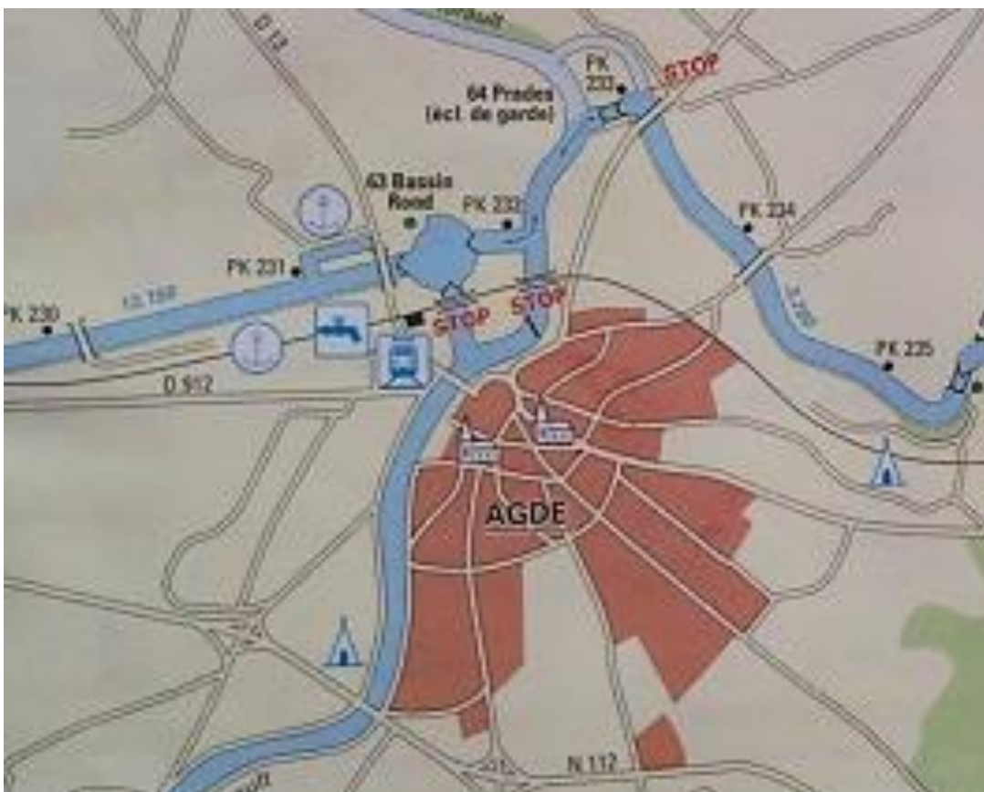
Přístaviště bazénového typu mimo plavební cestu s jedním vjezdem a výjezdem.
