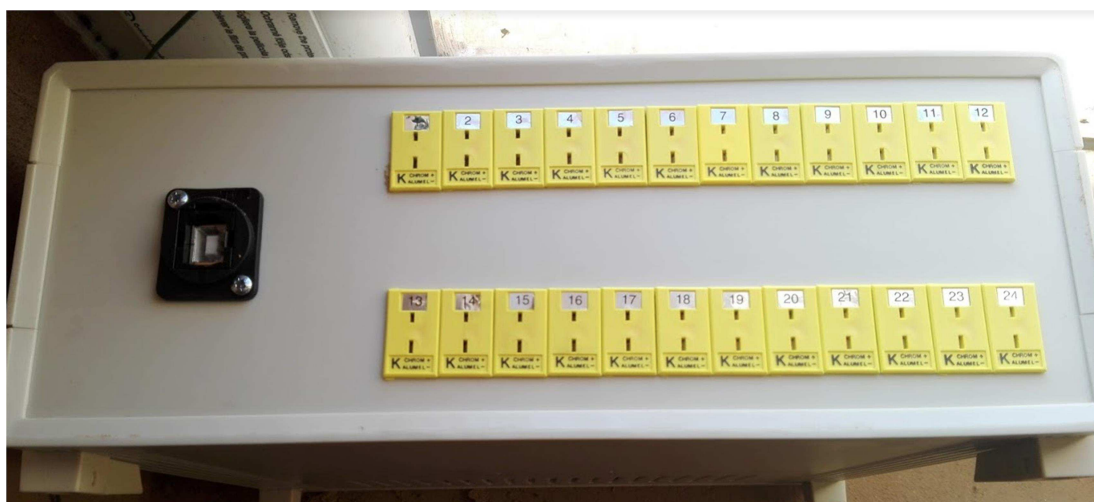
Obr. č. 30 Ústředna pro zaznamenávání naměřených dat
