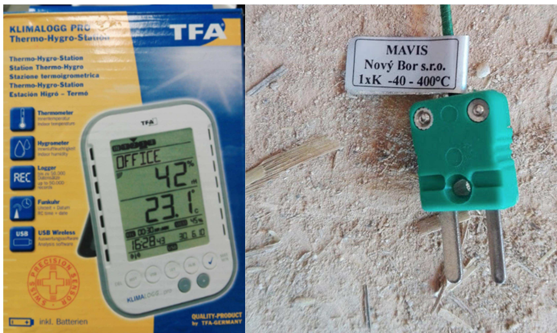
Obr. č. 29 Čidla měřící teplotu experimentálního objektu
