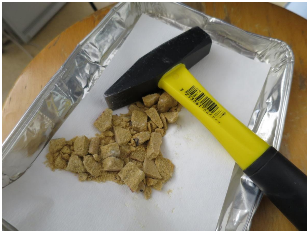
Obr. 3.11 Rozdrcený vzorek hořického pískovce.
