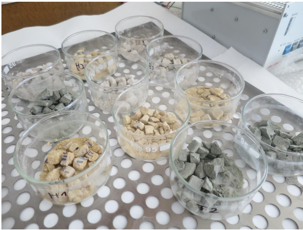
Obr. 3.13 Vzorky v konečné fázi experimentu připravené na vážení (zjištění DWL ).
