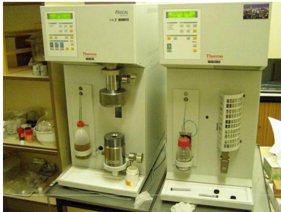
Obr. 3.2 Rtuťový porozimetr PASCAL 140 a 440 [30].
