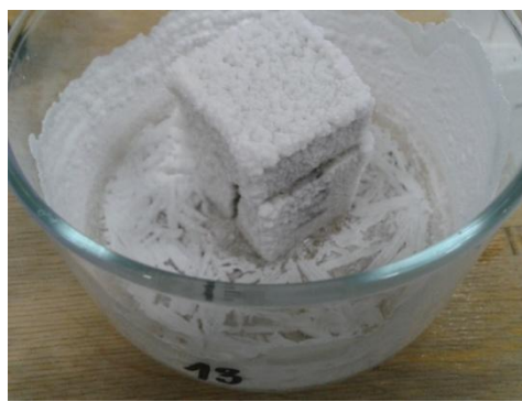
Obr. 3.16 Vzorky v klimatické komoře po prvních pěti cyklech.
