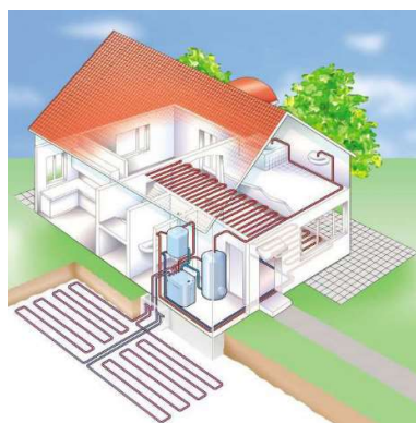
Obrázek 8 – Tepelné čerpadlo - kolektor
