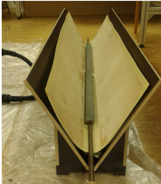
Obr. 7.1: Přípravek pro ohýbání překližkových plátů na potah křídla včetně zkušební vzorku; zdroj: vlastní
