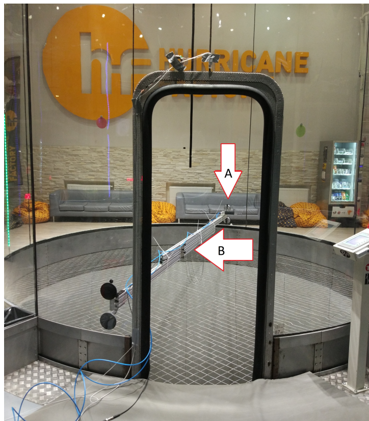
Obrázek 3.1: Měřicí aparatura; A - Prandtlova sonda s unašečem, B - Traverzér
