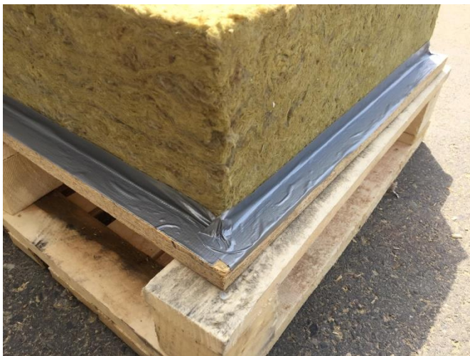
Obr. 28: Zajištění tepelné izolace proti vniknutí chladu
