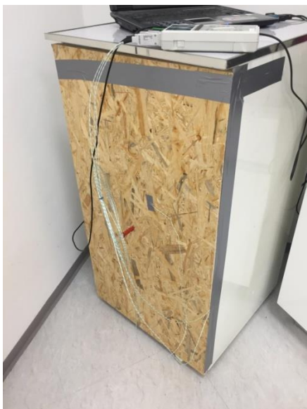
Obr. 31: Vložení připravené konstrukce do lednice a zajištění lepicí páskou
