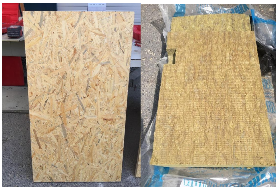
Obr. 25: OSB deska a tepelná izolace o potřebných rozměrech
