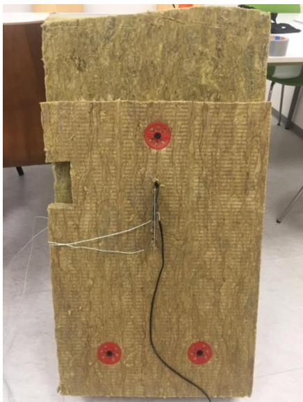
Obr. 30: Umístění snímacích zařízení na připravenou konstrukci
