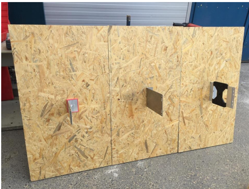
Obr. 26: Namontované testované konzoly na OSB deskách
