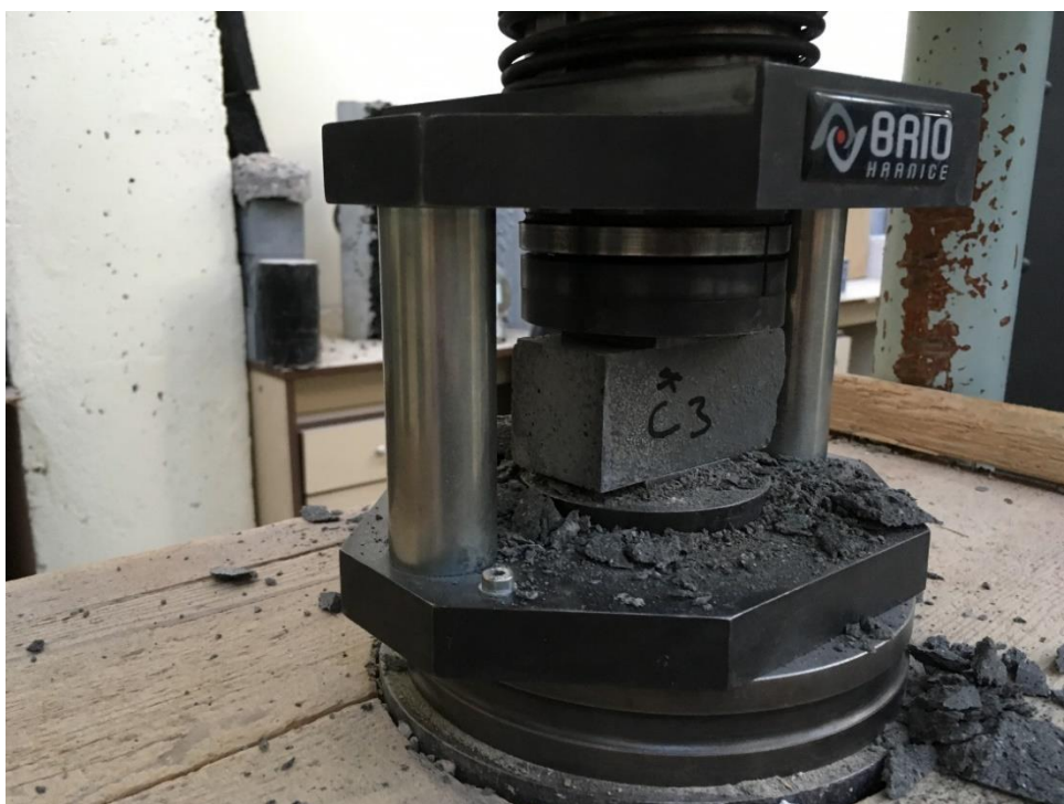
Obr. 2.11 Tlaková zkouška na ½ trámečku
