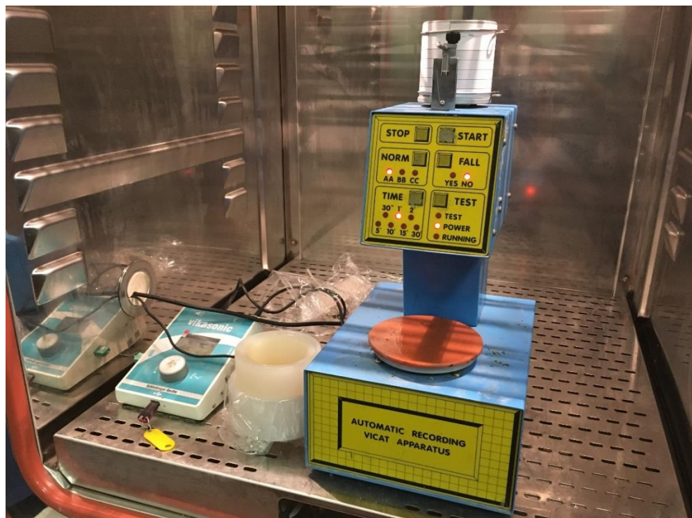
Obr. 2.24 Vikasonic umístěný v klimatizační jednotce (vlevo)
