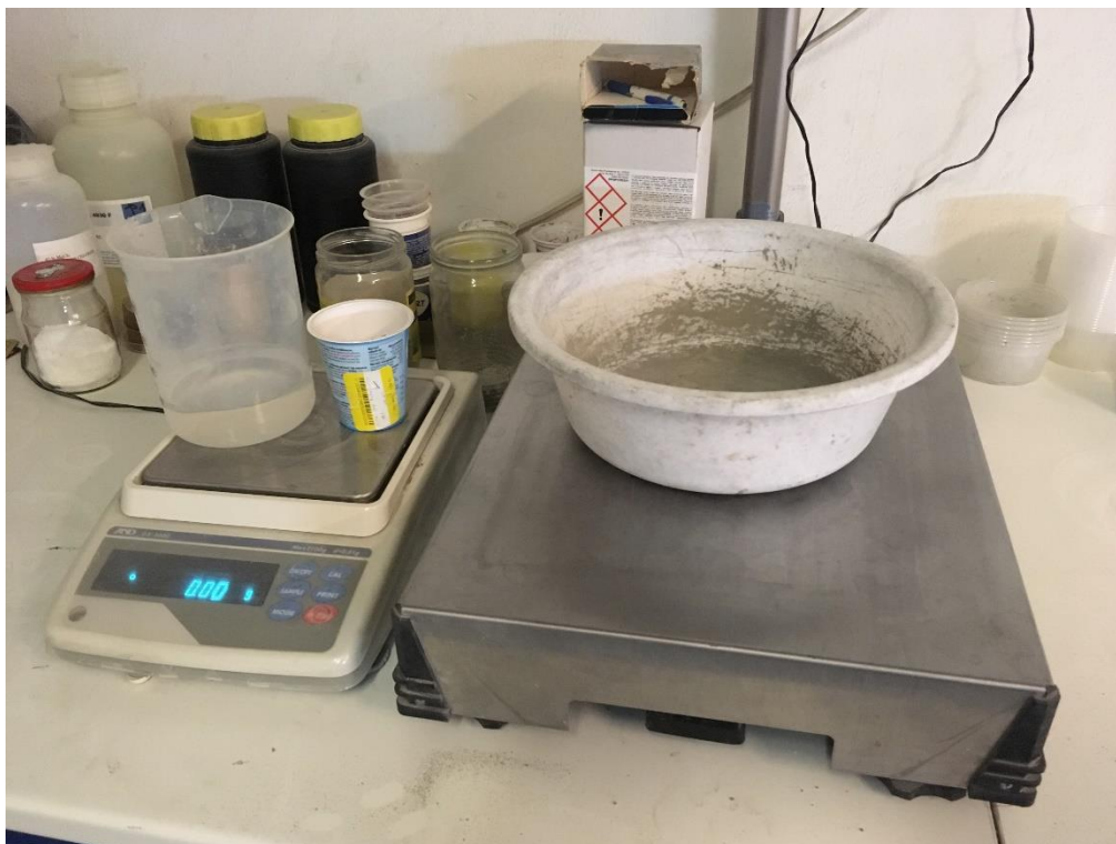
Obr. 2.4 Vážení jednotlivých složek cementového kompozitu
