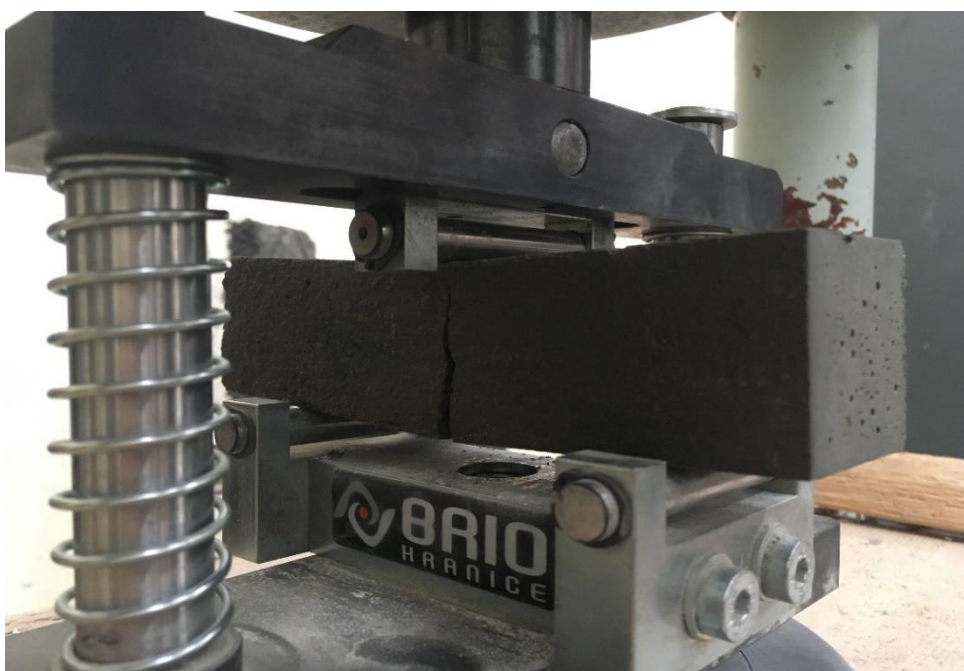
Obr. 2.10 Typické porušení při zkoušce v tahu ohybem
