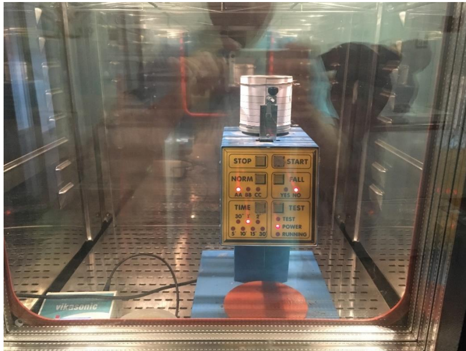
Obr. 2.21 Vicatův přístroj umístěný v klimatizační jednotce
