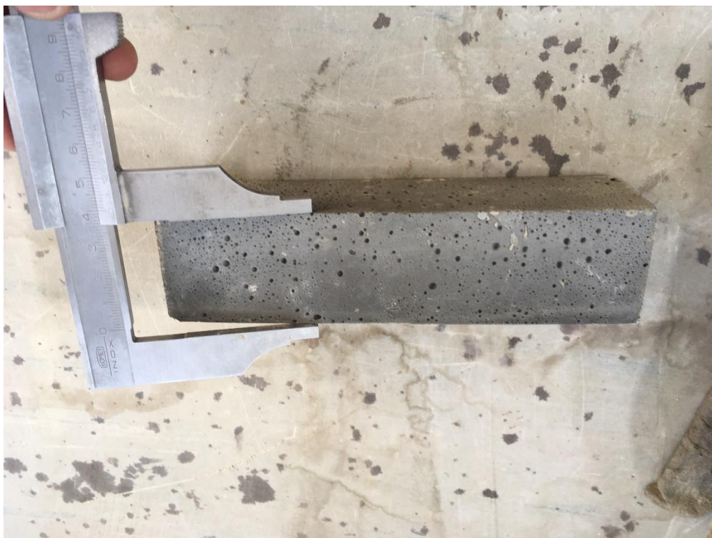
Obr. 2.8 Měření vzorku pomocí posuvného měřidla
