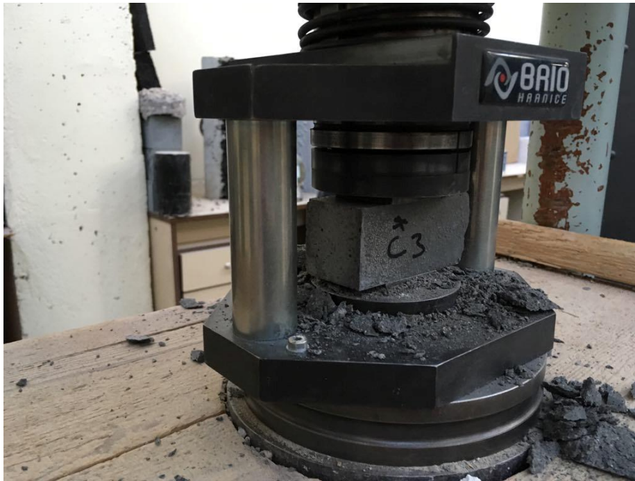
Obr. 1.15 zkouška pevnosti v tlaku
