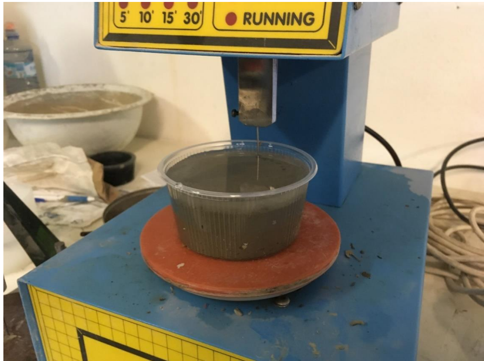
Obr. 2.13 Zkouška vzorku A v automatickém Vicatově přístroji
