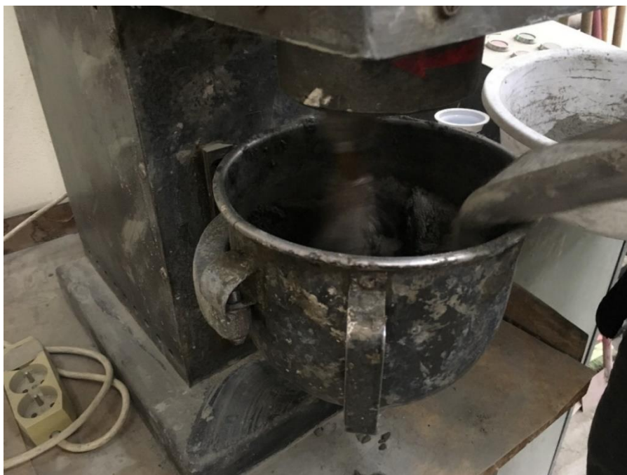
Obr. 2.6 Míchání směsi v automatické míchačce
