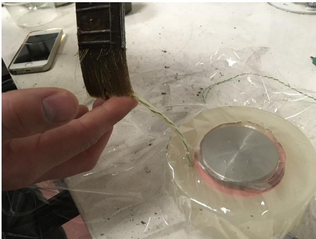
Obr. 2.17 Mazání přístroje pomocí hydrofobního gelu
