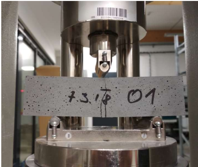
Obr. 24 – trámeček po první fázi zkoušky tahu za ohybu (foto: Žalský)
