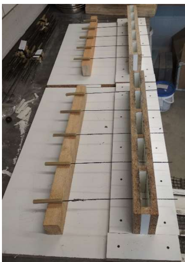
Obr. 20 – bednění pro zkoušku soudržnosti (foto: Žalský)
