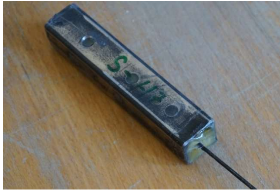
Obr. 17 – Nově provedená koncová úprava rovingu pro tahovou zkoušku únosnosti (foto:Žalský)
