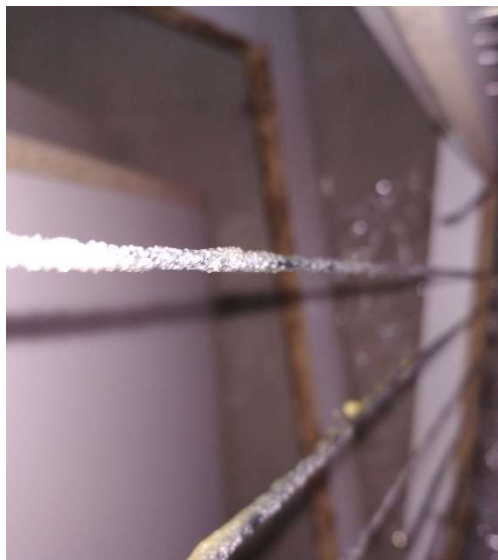
Obr. 15 – detail opískování rovingů (foto: Žalský)
