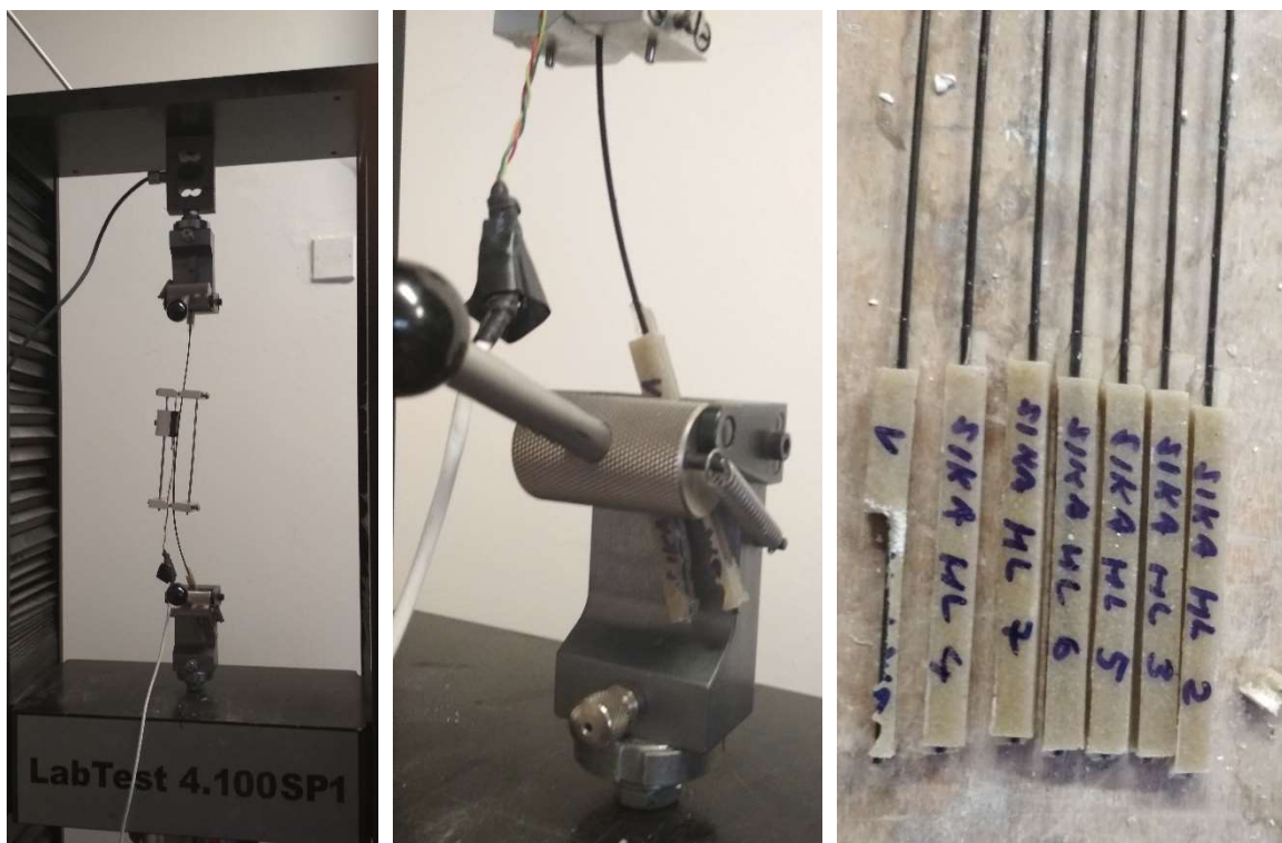
Obr. 16 – Vlevo uchycení vzorku S-H-1 do trhacího zařízení, uprostřed porušení objímky v upínacích kleštích, vpravo porovnání s ostatními vzorky (foto: Žalský)
