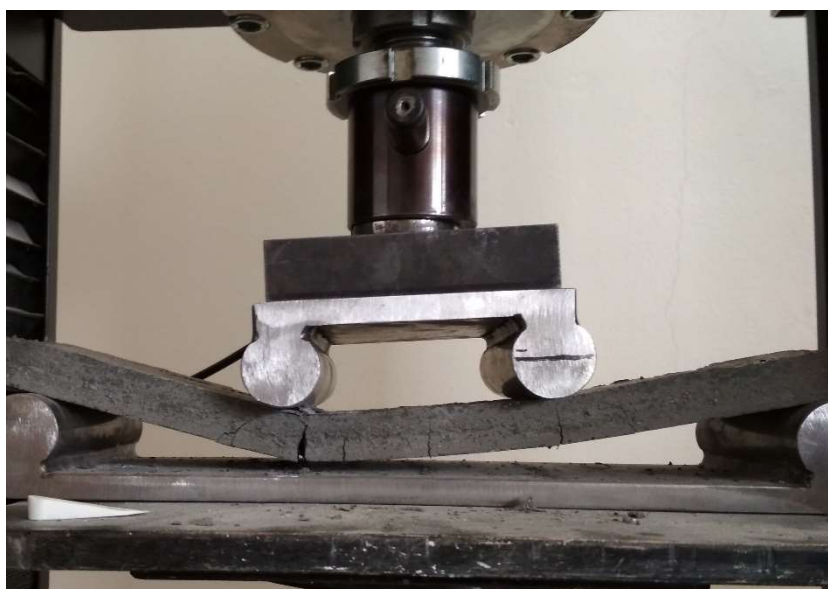
Obr. 26 – Vzorek při destruktivní zkoušce čtyřbodovým ohybem (foto: Žalský)
