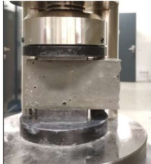
Obr. 25 – tlaková zkouška na trámečku při fázi dva (foto: Žalský)
