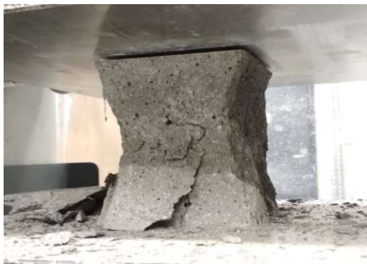
Obr. 23 – rozdrčený vzorek č.1. Tvar porušení se shoduje s normovým porušením a všechny tři vzorky vypadali srovnatelně.
