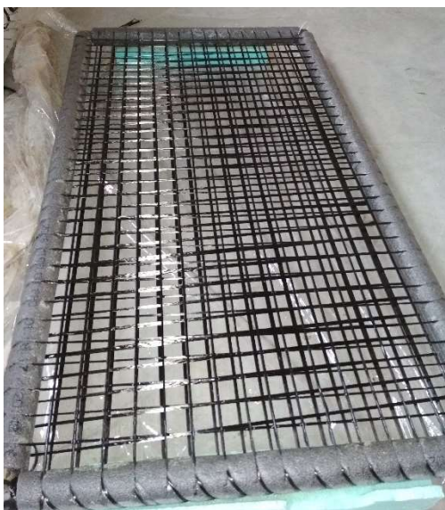
Obr. 14 – Síť vytvořené z uhlíkových vláken a impregnované pryskyřicí (foto: Žalský)
