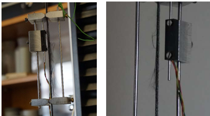
Obr. 31 – Chybné spolupůsobení uhlíkových vláken (foto: Žalský)
