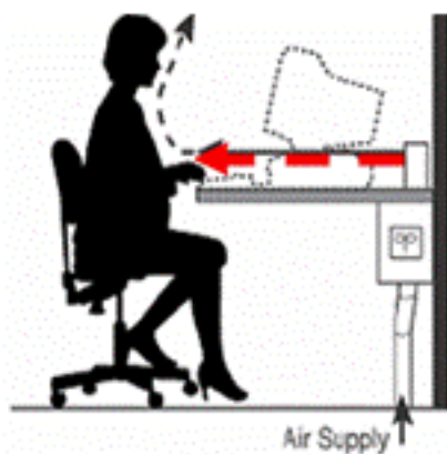
Obrázek 14: Přívod vzduchu pomocí vyústky v nábytku [17]
