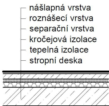
Obrázek 23: Charakteristická skladba podlahy v bytech
